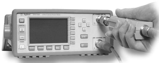
6. Lorsque la sonde est connectée au connecteur POWER REF, vous pouvez faire une mise à zéro et un étalonnage rapide du chemin de mesure en appuyant sur
