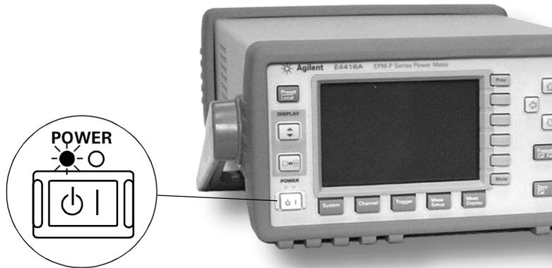
3. Mettez le wattmètre sous tension, et vérifiez si la diode verte s'allume.
