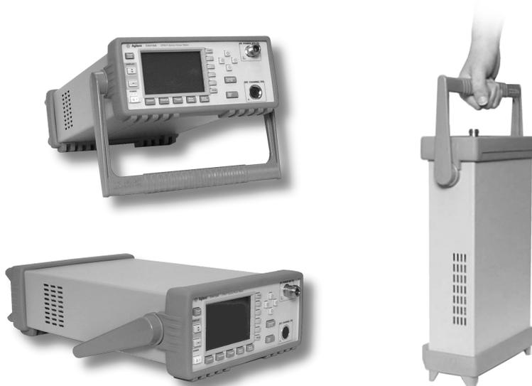
Tirez la poignée vers l'extérieur, faites-la tourner à la position souhaitée, et relâchez-la dans l'une des trois encoches.
