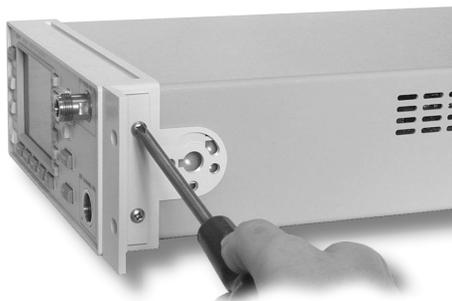
5. Installez deux plaques d'assemblage frontal sur chaque wattmètre.
