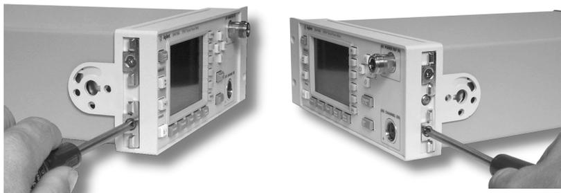
6. Enclenchez les plaques d'assemblage à l'avant des wattmètres.
