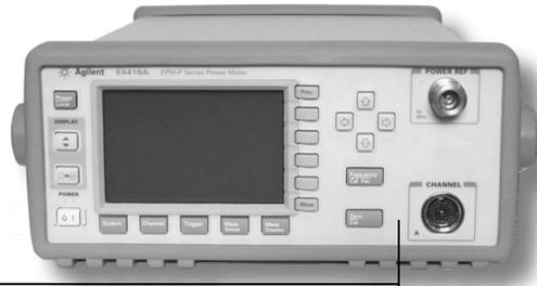
Ces touches et connecteurs associés aux chemins de mesure se trouvent sur le côté droit du panneau avant.
