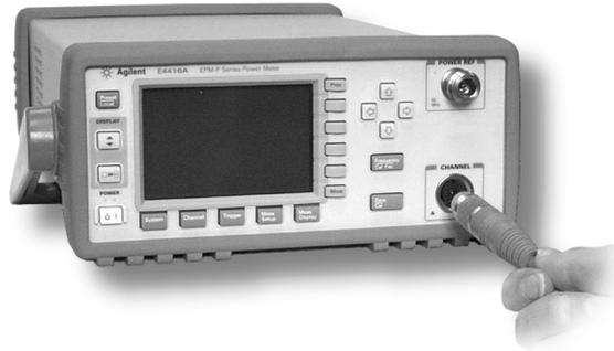
3. Vérifiez si le message **Reading Sensor** (Lecture de la sonde) apparaît brièvement.
