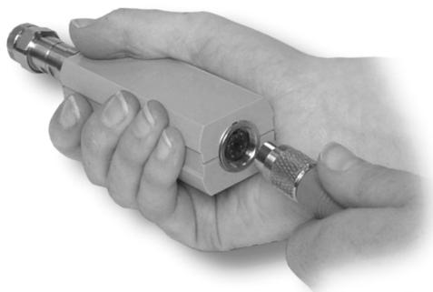
2. Connectez l'autre extrémité du câble E9288 au connecteur du CHEMIN A (ou du CHEMIN B).
